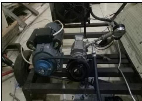
Gambar 1. Komponen-komponen sistem kompresi uap rancangan
